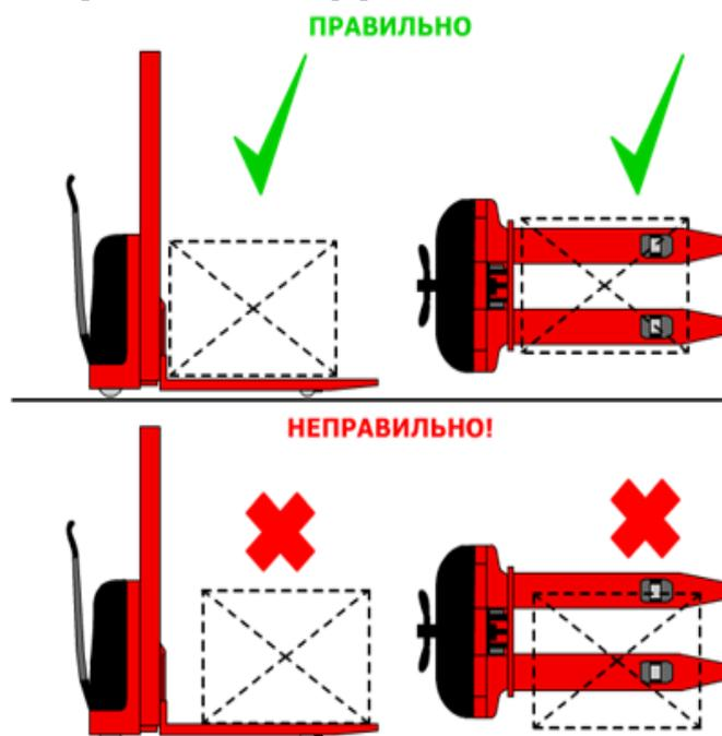
При использовании, вилы должны быть помещены под груз так, чтобы груз опирался на каретку вилок. Затем следует немного поднять вилы, чтобы груз устойчиво встал на вилы.
