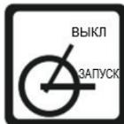
Поверните ключ по часовой стрелке в положение ЗАПУСК, подождите 2 или 3 секунды, а затем запустите установку. Установка может запуститься со 2–4 раза.
