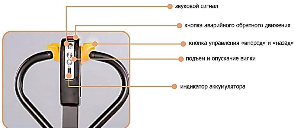
Рис.6 - Функциональные кнопки на ручке
